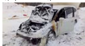
В ходе осмотра автомобиля, было установлено, что под капотом (в моторном отсеке) выгорели все резинотехнические и пластмассовые детали и механизмы, выгорел защитный слой изоляции на силовой электропроводке, частично разрушился аккумулятор. Салон автомобиля имеет сильное запыление, и оплавление, в передней, силовой панели имеется прогар в пластике, сама пластиковая панель оплавлена.
