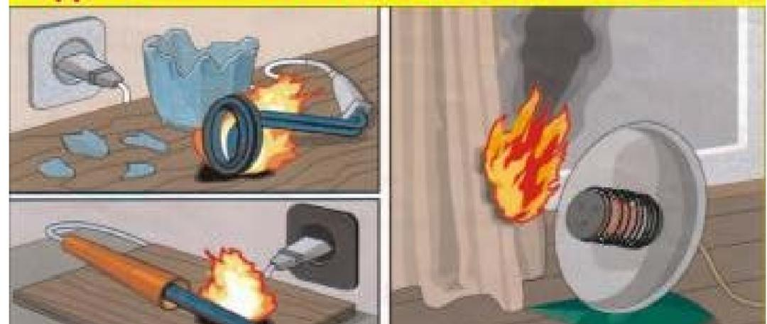
**При изучении причин возникновения пожаров в электроустановках жилых домов, необходимо заострить внимание на то, что чаще всего пожары возникают в результате коротких замыканий, перегрузок электросети, искрения и нагрева контактных соединений. Много пожаров возникает при нарушении правил использования бытовых электронагревательных приборов (утюги, чайники, электроплиты и т.д.).**
